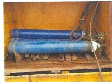
Slika lijevo: Treneska građevinska mašina koja obavlja potrebne građevinske poslove, prevozi radnike i vozi prikolicu za smještaj potrebnih tehničkih sredstava (plinske boce, kompresor,...), alata i materijala. Slika desno: Plinske boce i presjekači za sječenje šine u području puknuća.
