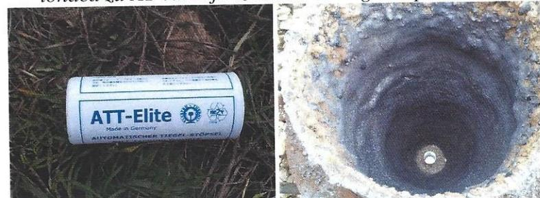
Slika lijevo: Patron za zatvaranje otvora lijevka. Slika desno: unutrašnjost lonca za AT varenje sa postavljenim patronom u otvoru lijevka.
