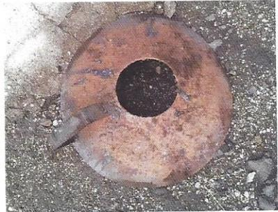
Slika lijevo: Zavrtanje veznog vijka i maticice na oboruču i fiksiranje oba tijela lonca u čuvrsti spoj. Slika desno: Poklopac lonca za AT varenje.
