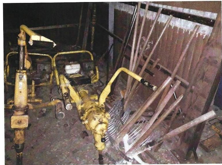
*Ručne motorne građevinske mašine trifonjerke za odvrtanje vijaka i bušenje rupa za vijeke i razni alati Radne jedinice ZOP Zenica*
