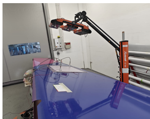
Slika 14: Nanošenje dva sloja karbonskih vlakana i dva sloja staklenih vlakana u polimernoj matrici tehnologijom lijepljenja (autorska fotografija)
